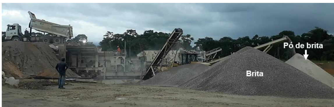
Figura 2 - Sistema de beneficiamento da pedreira Santa Monica utilizado para a produção de brita. Seta no lado direito indica a pilha de subproduto onde foram coletadas as amostras de pó de brita.
