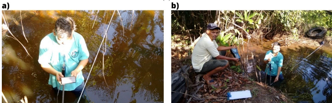
Figura 17 - Inserindo as informações no medidor FlowTracker (a) e a Coleta dos dados do Igarapé Água Preta (b).
