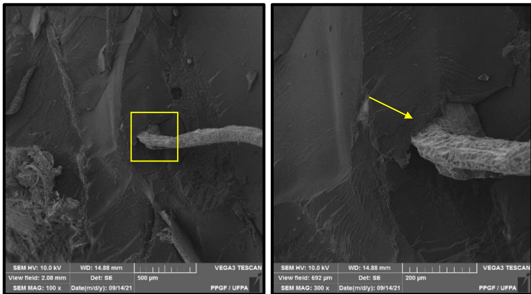
Figura 47 – MEV da fratura de um corpo de prova com 50% de fibras de açai e curauá; (a) visão geral em 100x e (b) detalhe da superfície da fratura em 300x mostrando pull out da fibra de curauá.
