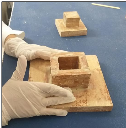
Figura 22 – Revestimento de desmoldante no molde de madeira.
