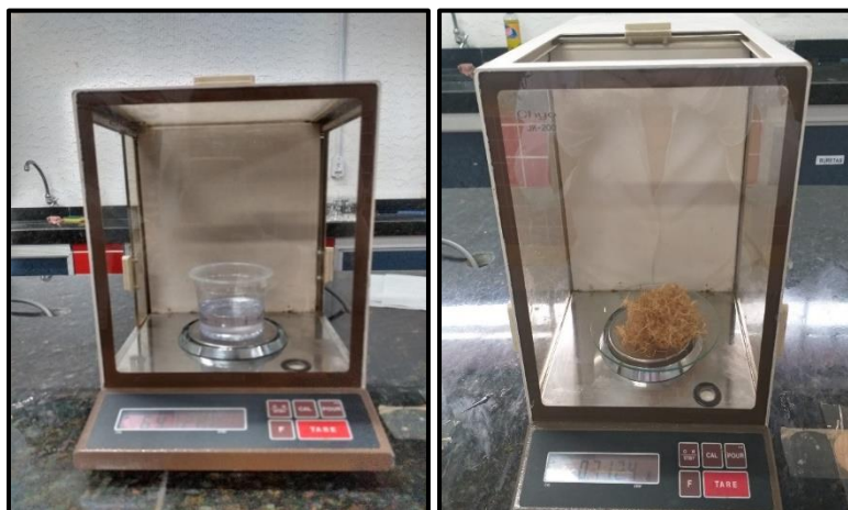
Figura 20 – a) Pesagem de resina, b) e c) fibras na balança analítica.
