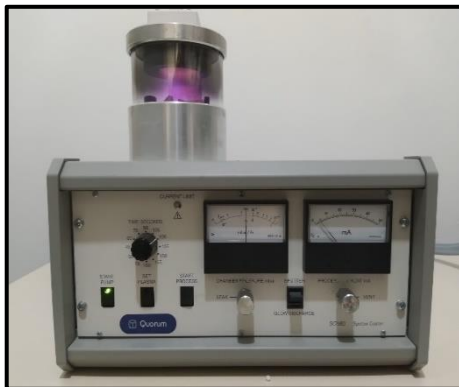
Figura 27 - Metalizadora (marca Quorum Sputtery Coater SC7620) realizando a metalização.
