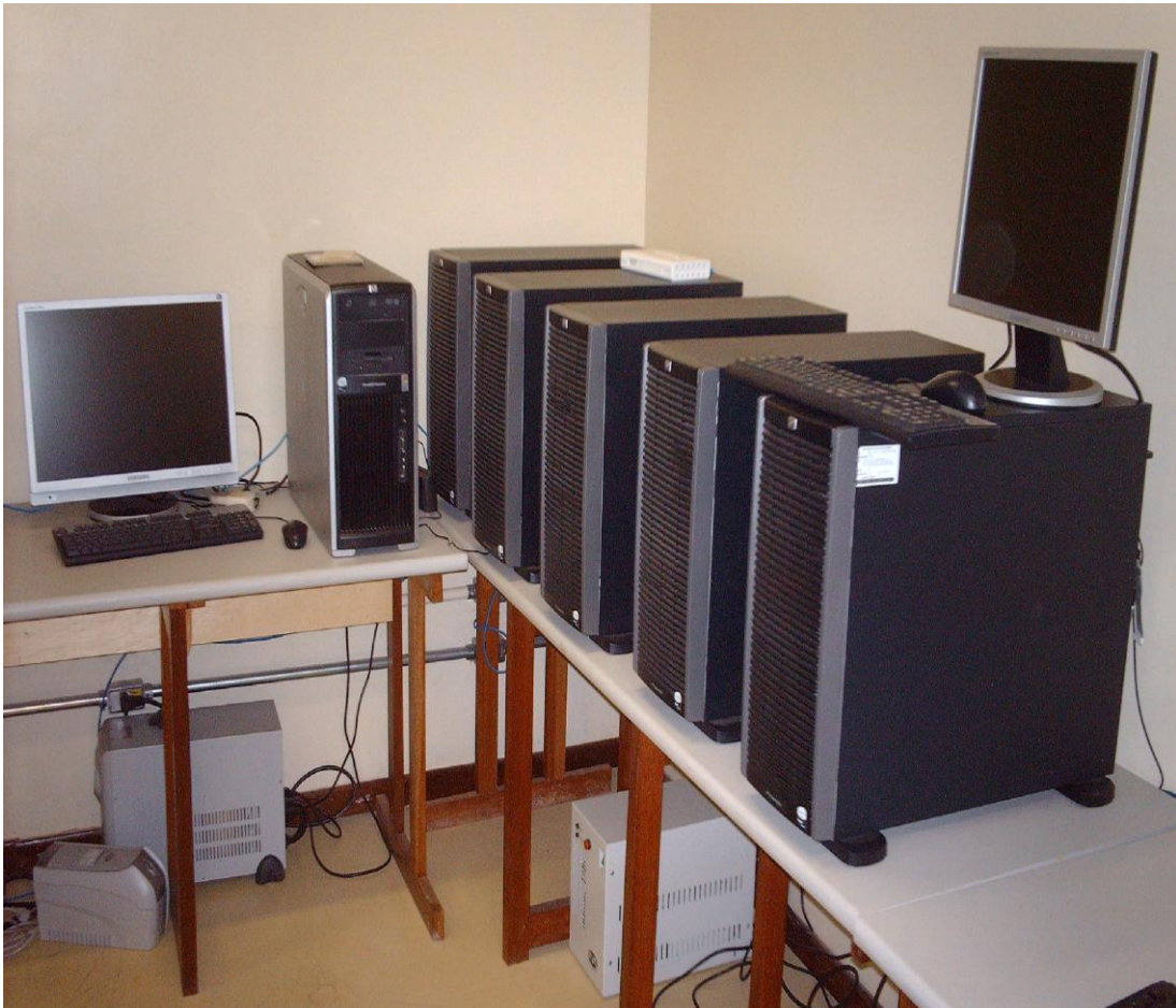
Figura 2: Ilustração do Cluster RPCH – UFPA com 48 processadores.
