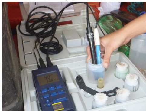
Figura 09 – Registro dos dados hidroquímicos com o analisador multiparâmetros.
