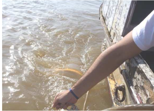
Figura 07 - Coleta de material particulado através de arrastos horizontais com rede (40 \mu m).
