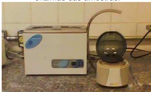
Figura 10 – Ultrassom e mini centrífuga utilizados para fazer a extração de proteínas e enzimas das amostras.
