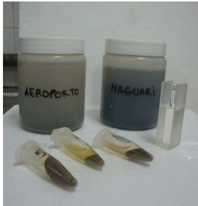
Figura 08 – Amostras armazenadas em potes de polietileno (120 mL) e eppendorfs (1,5 mL).
