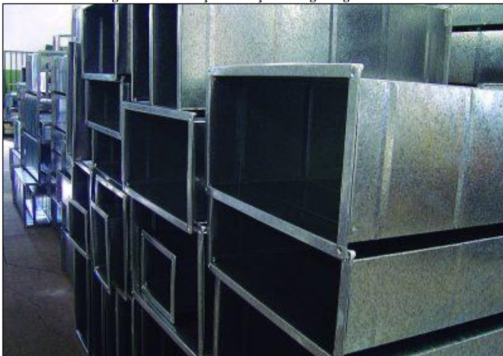
Figura 17. Tubulações de seção retangular galvanizado
