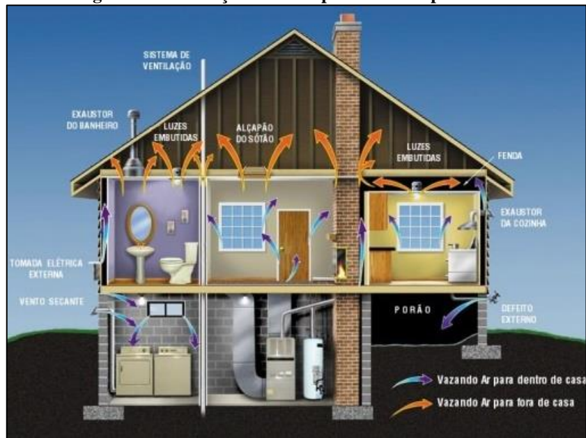
Figura 10. Infiltração de ar na parte interna por frestas
