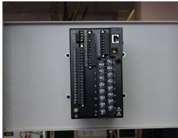
Figura 26 - parte traseira do relé novo.
