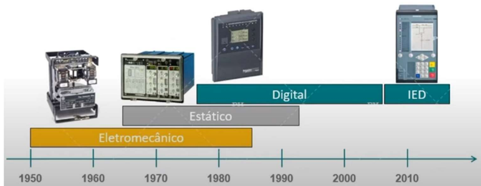
Figura 3 - Evolução dos relés de proteção.
