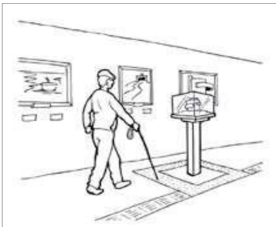
Figura 10. Percursos no interior de um museu com pisos guia e pisos de alerta.
