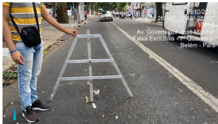
Figura 16 – Treliça Metálica para aferição das deflexões da trilha de roda
