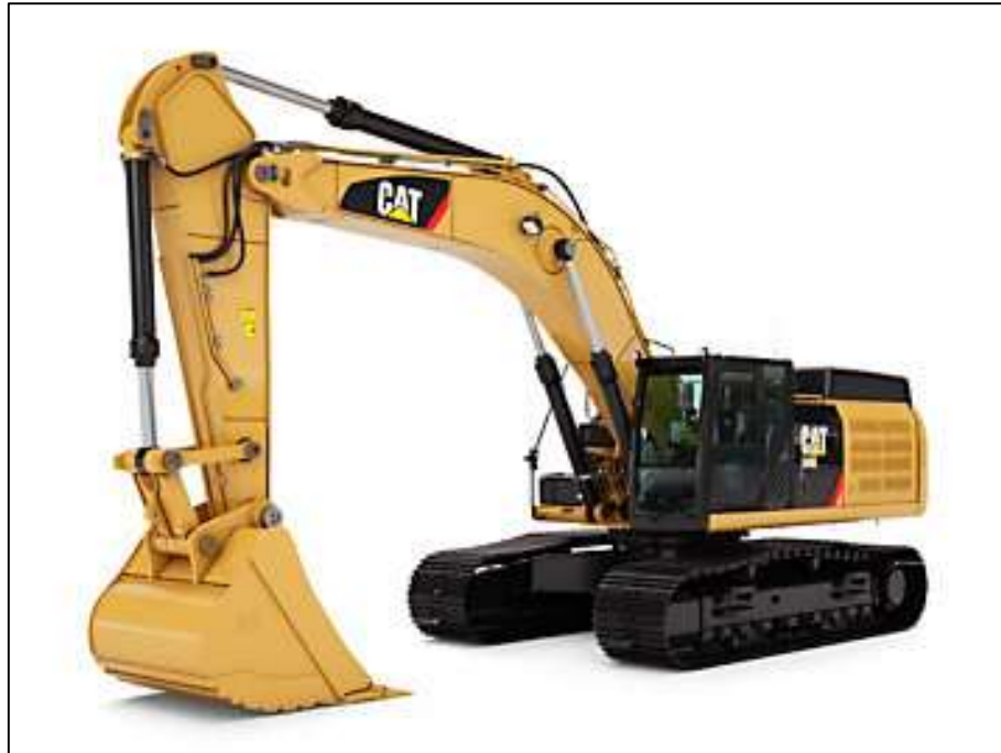
Figura 5.2 – Escavadeira hidráulica CAT 349D.
