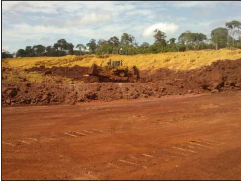
Figura 5.5 – Trator executando a escarificação da bauxita.
