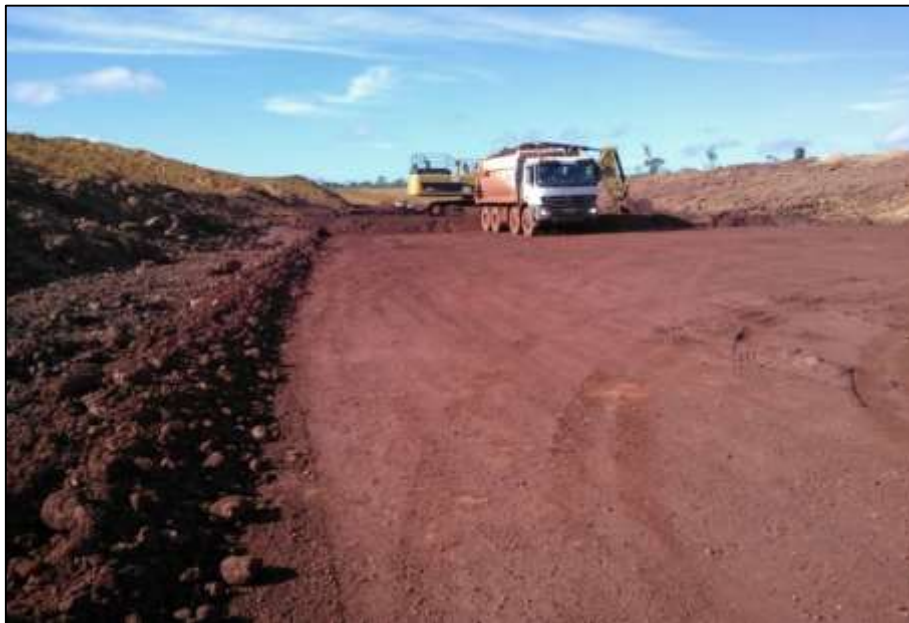
Figura 5.6 – Carregamento de minério em caminhões basculantes.
