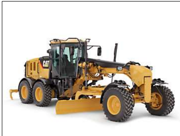
Figura 5.4 – Motoniveladora CAT 140M.
