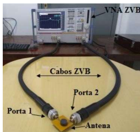
Figura 1 – Setup de medição de antenas em microfita: antena medida com duas portas de alimentações
