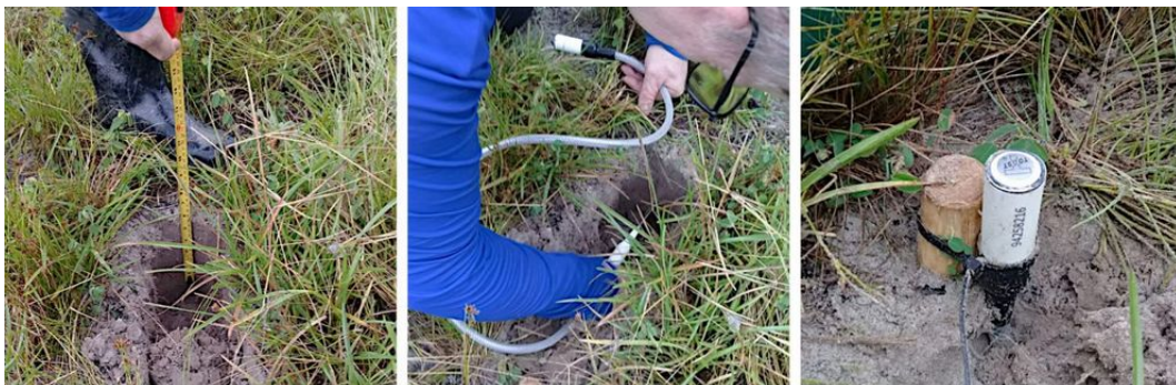
Figura 2: Fotos mostrando a instalação dos sensores de umidade.
