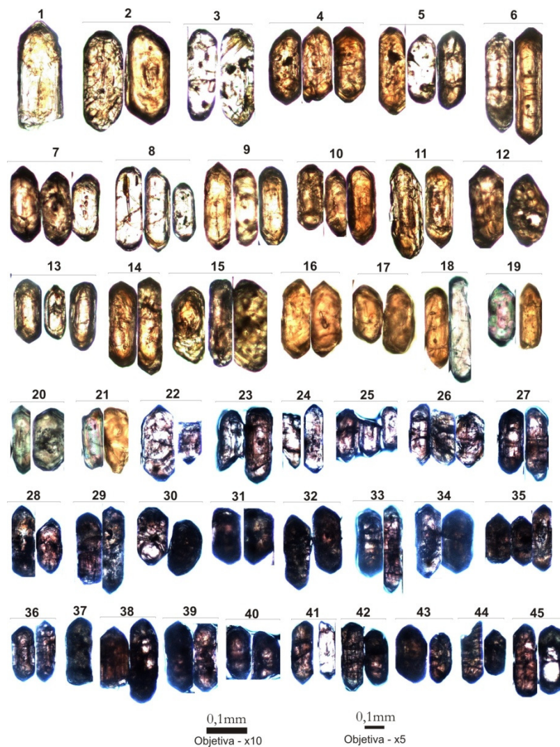
Fig. 6.25: Fotomicrografias de cristais de zircão da amostra de monzogranito (LT-79) com aumento de 10x e 5x, obtidos das frações granulométricas 180-125 \mu\text{m} e 250-180 \mu\text{m} .
