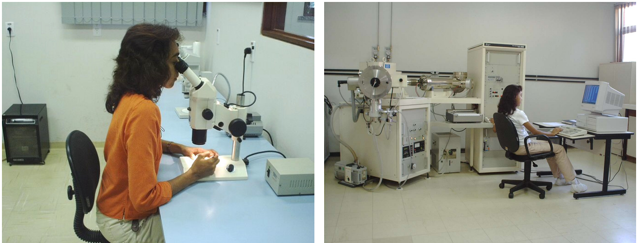
Fig. 5.3: A) Estereomicroscópio; B) Espectrômetro de massa marca Finnigan modelo MAT262 utilizado para a obtenção das composições isotópicas.
