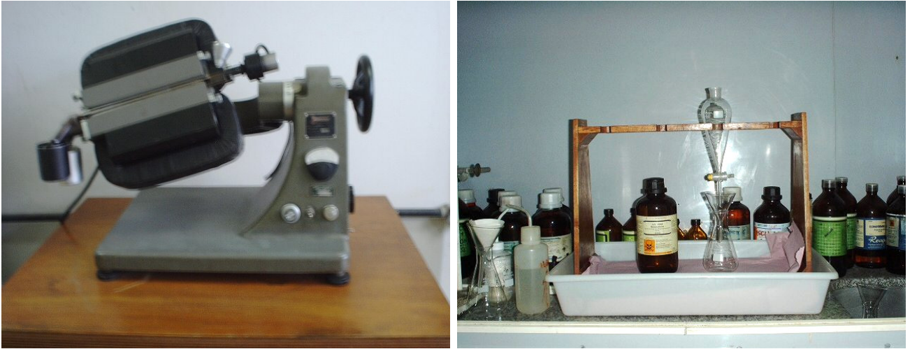
Fig. 5.2: Instalados no Laboratório de separação de minerais do Pará-Iso. A) Separador magnético Frantz; B) Sala de líquidos pesados (bromofórmio).
