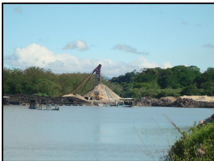
Figura 25: Detalhe da draga flutuante na cava 2, ano de 2009. Fonte: Almeida 1 (2009).
