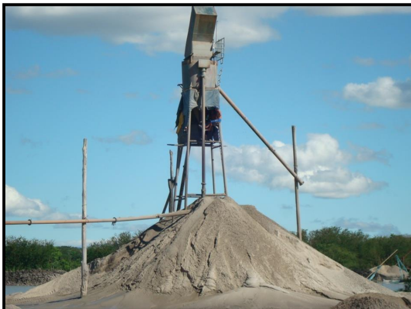
Figura 26: Classificador de areia instalado próximo do pátio da cava 2, ano de 2009.
