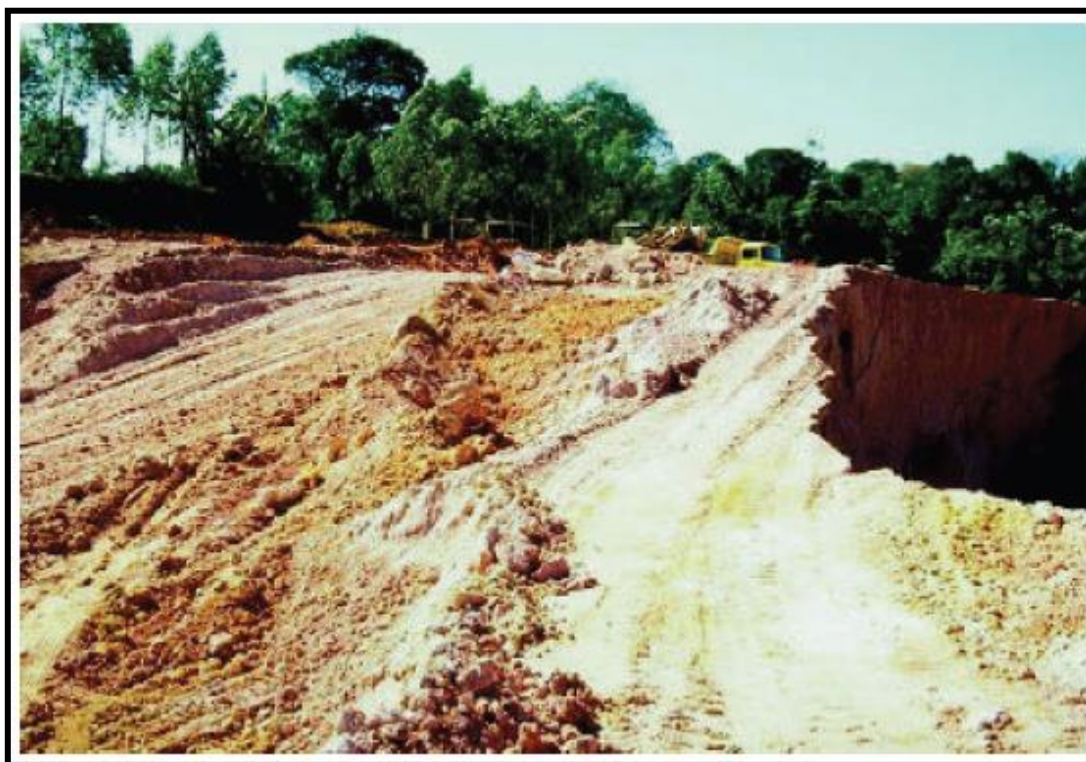
Figura 9: Vista de uma frente de desmonte, onde se observa, à esquerda, a retirada das camadas orgânica e argilosa do solo superficial - mais escuras - e exposição do material arenoso a ser lavrado - mais claro (São Paulo-SP).
