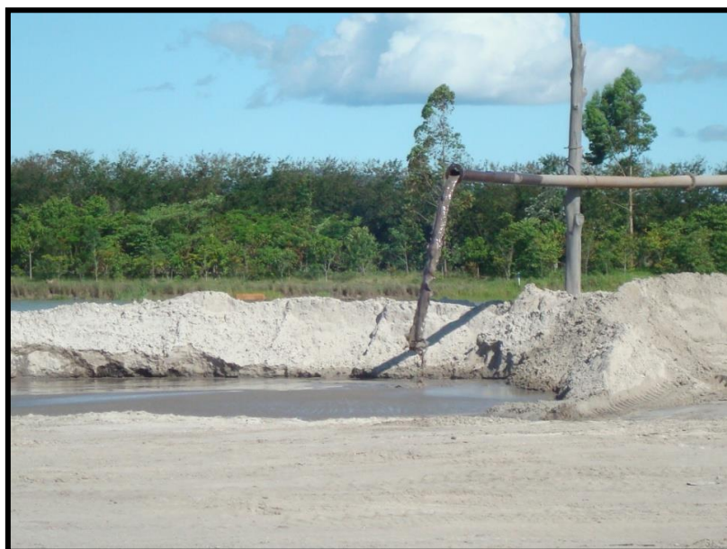
Figura 27: Finos de lavagem do classificador, em circuito hidráulico fechado, ano de 2009. Fonte: Almeida 1 (2009).
