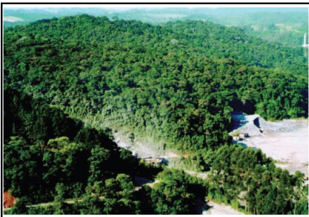
Figura 7: Vista da área de uma mineração de rocha para brita, onde se observa, à esquerda, a vegetação coberta de partículas sólidas provenientes da área dos britadores.
