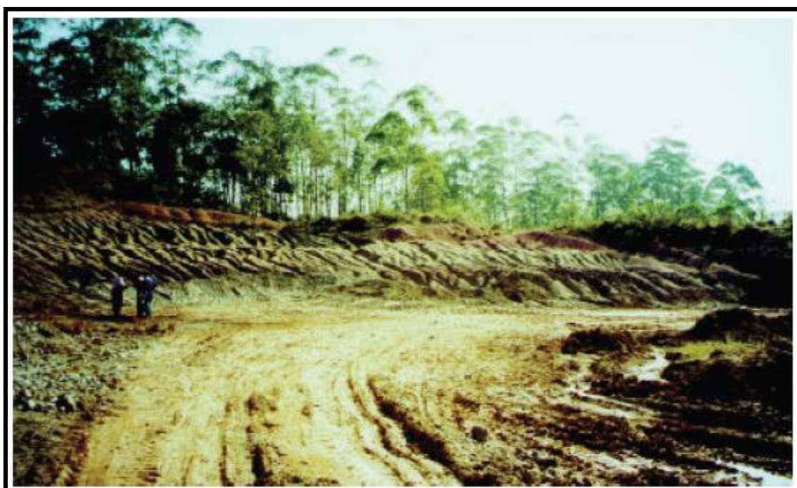
Figura 5: Vista de uma frente de lavra de argila, onde se observam sulcos de erosão.
