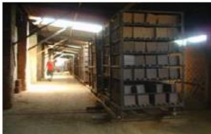
Figura 4 – Secagem natural dos blocos cerâmicos
