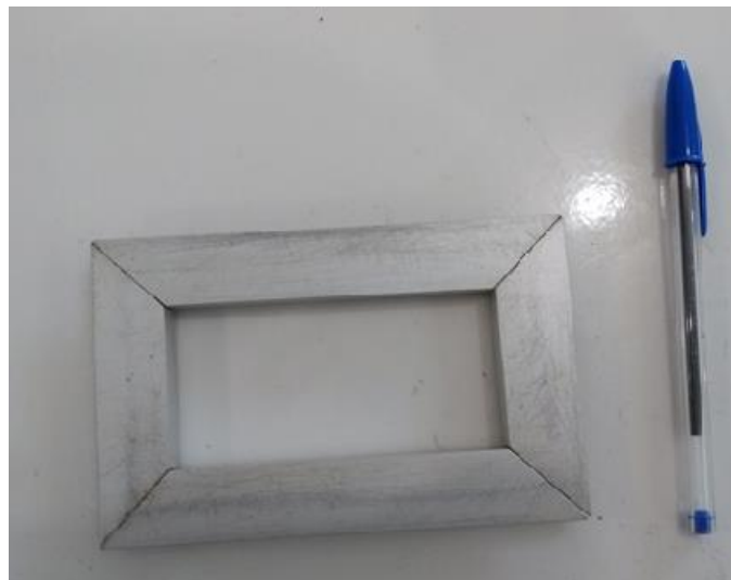
Figura 10 - Molde utilizado para a confecção dos corpos-de-prova
