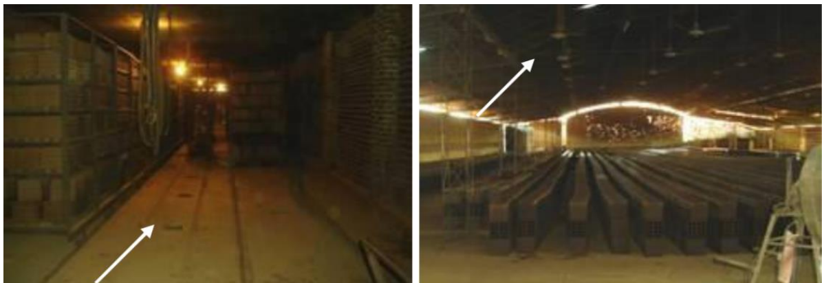
Figura 5 - Secagem artificial de blocos cerâmicos. a) secagem através de gases quentes e b) uso de ventilação para remover o ar saturado.
