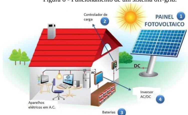
Figura 6 - Funcionamento de um sistema off-grid.
