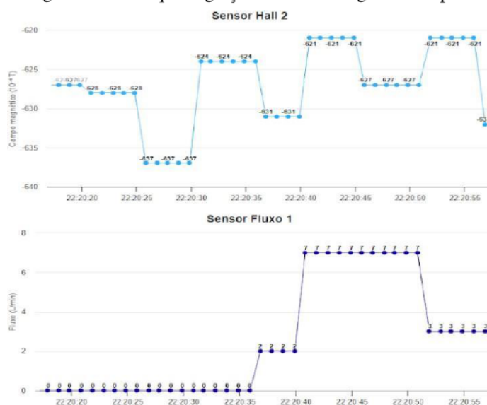
Figura 14 - O gráfico mostra que a ignição da bomba d'água não impacta na medição
