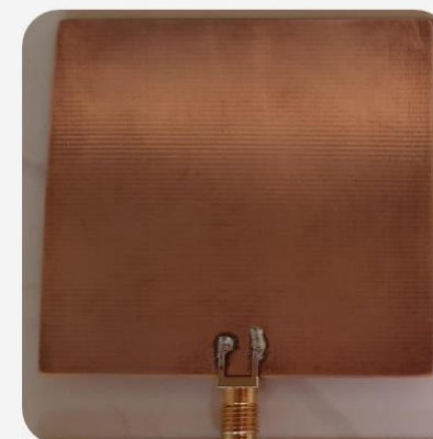
c) Vista inferior com conector soldado
