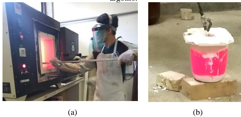
Figura 9- (a) Retirada do cadinho do forno para homogeneização do material; (b) Injeção do gás argônio.
