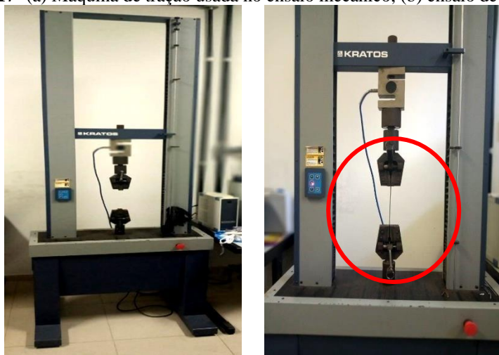
Figura 17- (a) Máquina de tração usada no ensaio mecânico; (b) ensaio de tração realizado em fio.
