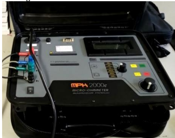
Figura 16- Microhmímetro usado no ensaio
