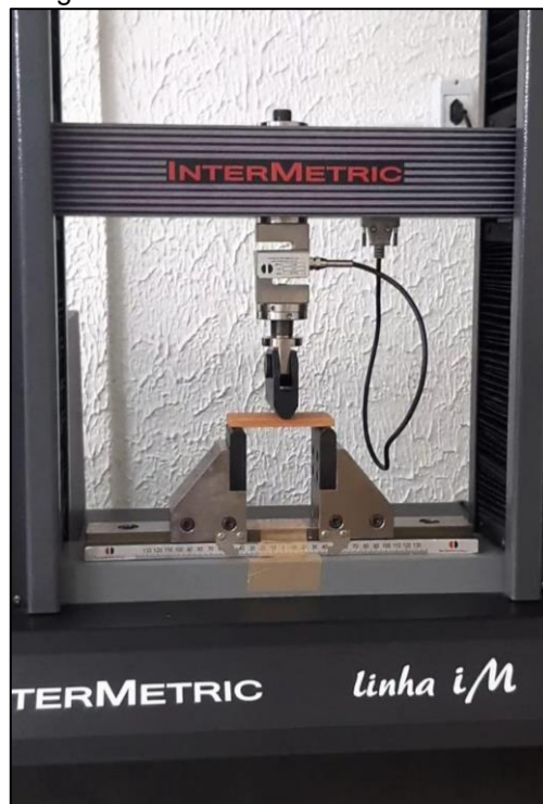
Figura 8 - Ensaio de Flexão dos CPs.
