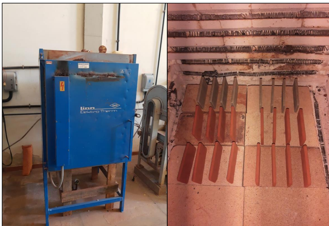
Figura 7 - Forno Utilizado e Disposição dos CPs.
