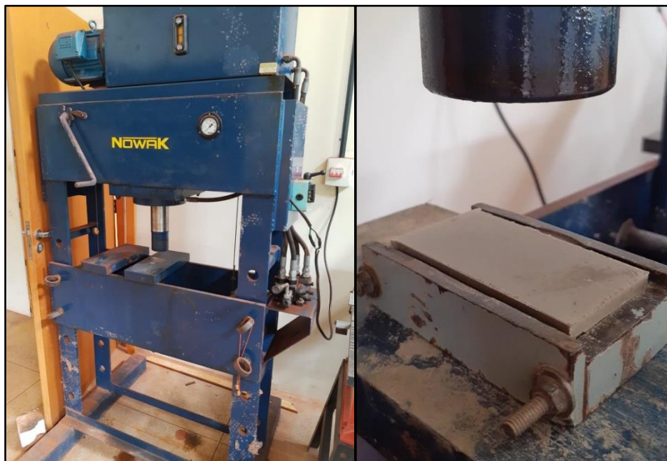
Figura 5 - Prensa e matriz utilizadas para conformação dos CPs.
