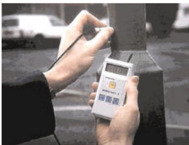
Figura 2.15. Medição de espessura em um tubo.
