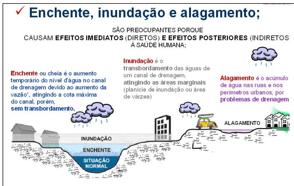
Figura 27. Imagem representando as características e conceitos dos termos enchente, inundação e alagamento.
