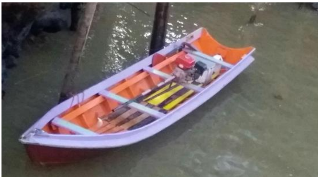
Figura 3: Foto do objeto de estudo (rabeta e motor rabudo): Seu nome científico é rabeta para barco, mais é conhecido pelos ribeirinhos como rabudo. Fonte: Acervo da autora.
