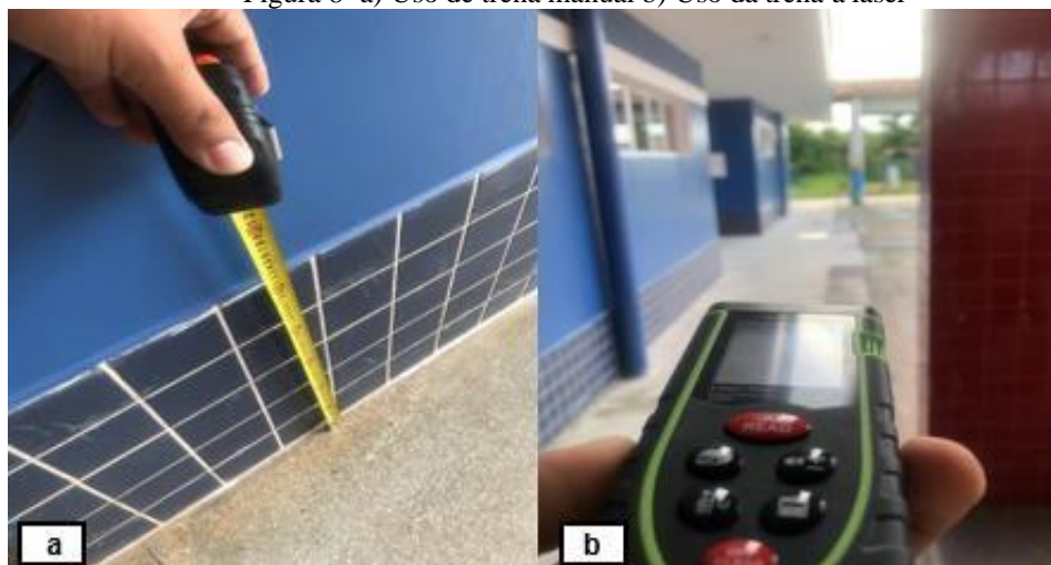
Figura 8- a) Uso de trena manual b) Uso da trena a laser
