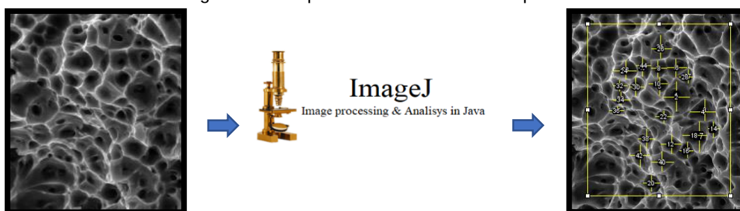
Figura 27 - Esquema de Análise dos Dimples.
