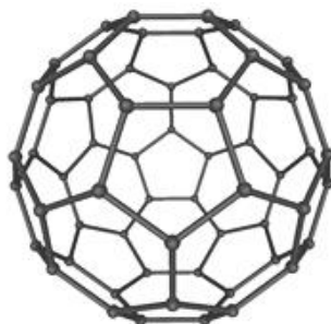
Figura 4 - Esquema da estrutura cristalina do Fulereno C60.
