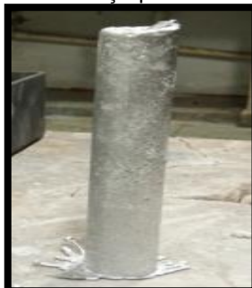
Figura 16 - Peça pós vazamento.
