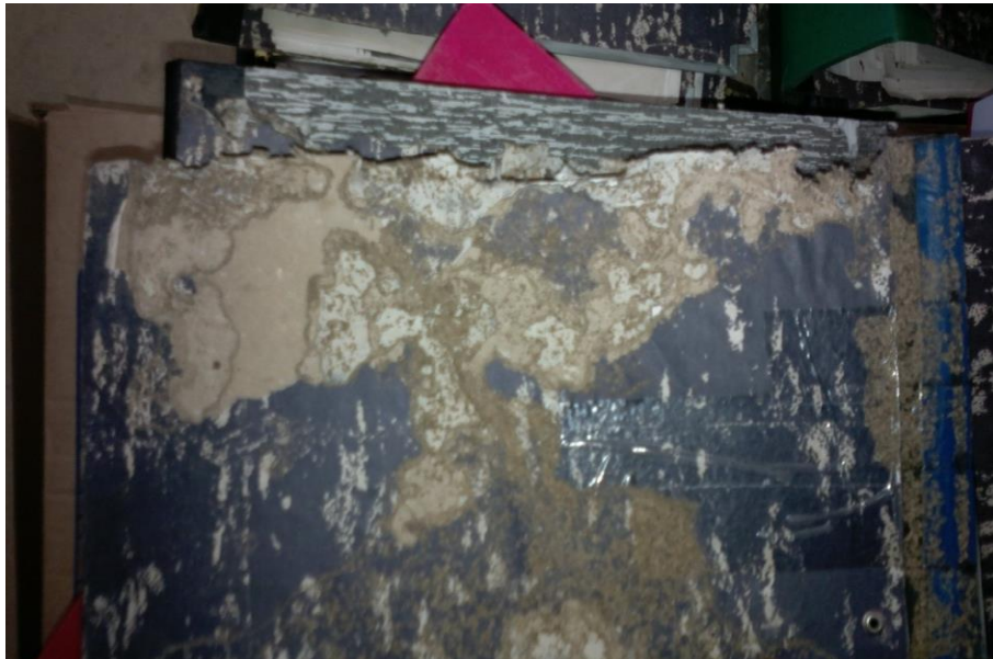
Figura 4 – Documentação deteriorada por agentes biológicos
