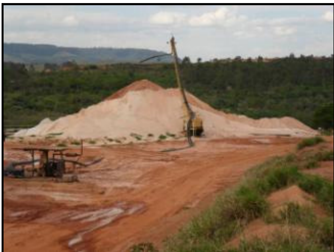
Foto 5.3.1-5 - Segundo Hidrociclone, disposto na lança da dragline, que forma a pilha em semicírculo.
