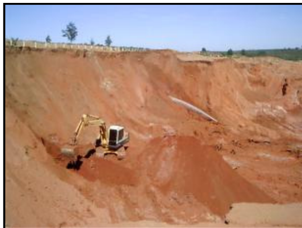
Foto 4.1.3.2-2 – Vista da frente de Lavra atual da REALMIX no processo 820.340/99. Notar pacote de arenito da Formação Piramboia.
