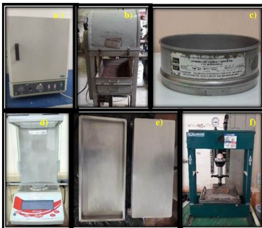
Fotografia 1 Equipamentos utilizados: a) Estufa; b) Moinho de bolas; c) Peneira; d) Balança digital analítica; e) Molde metálico; f) Prensa hidráulica.
