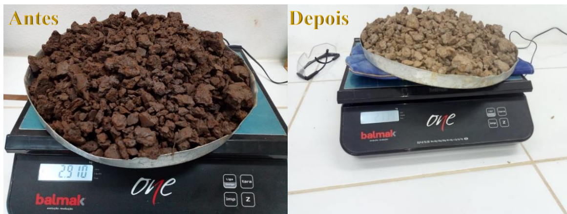
Fotografia 2- Antes e depois de secagem da argila em estufa
