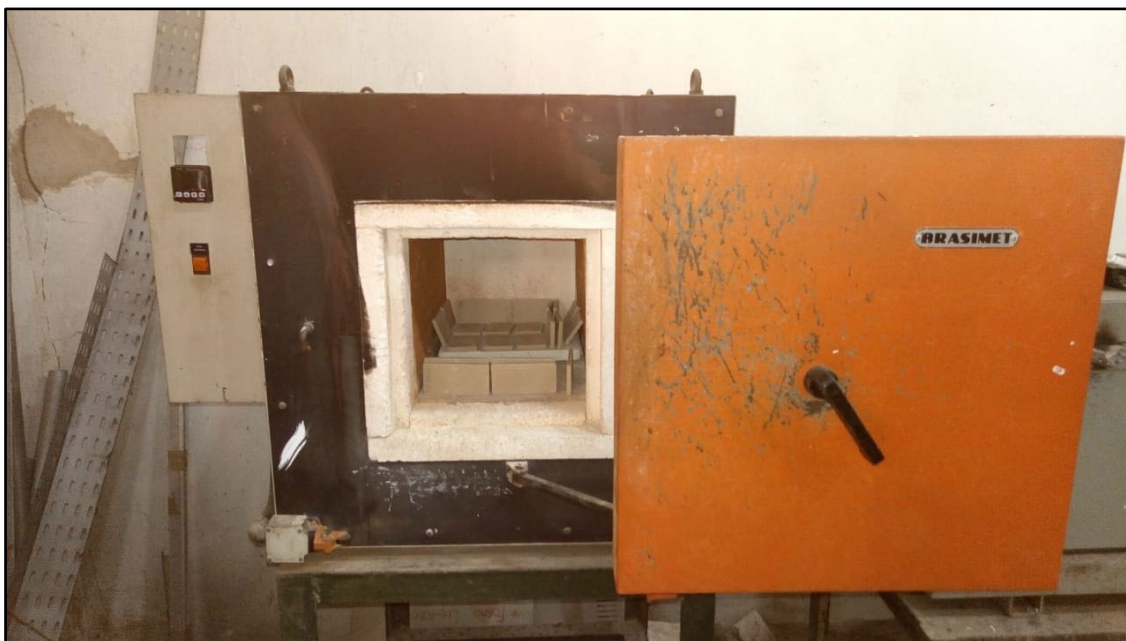
Figura 9 - Forno utilizado para a queima dos CP's
