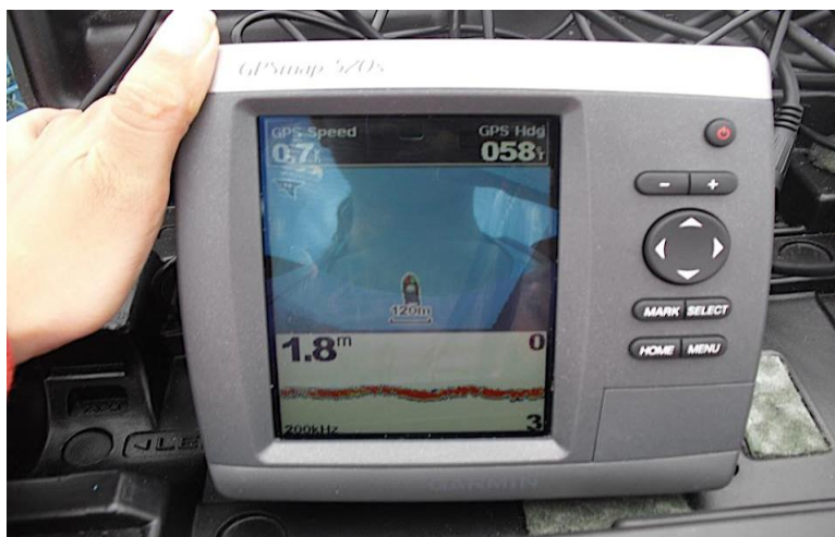
Figura 9 - Ilustração do ecobatímetro utilizado na realização dos perfis batimétricos.
