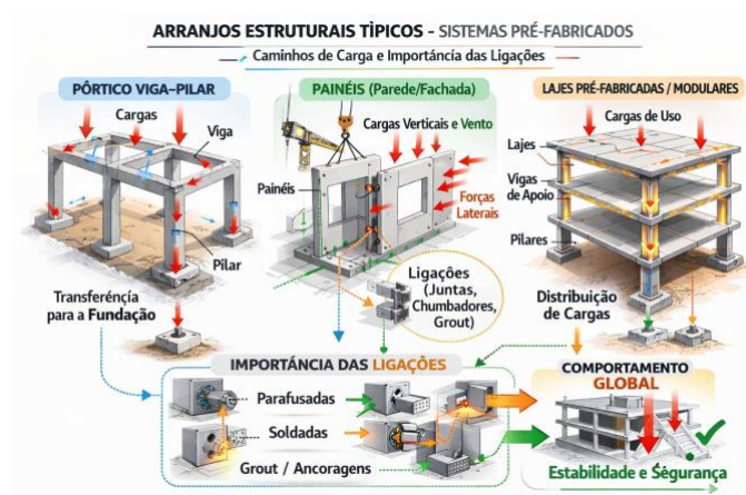
Figura 1 - Arranjos estruturais de sistemas pré-moldados
