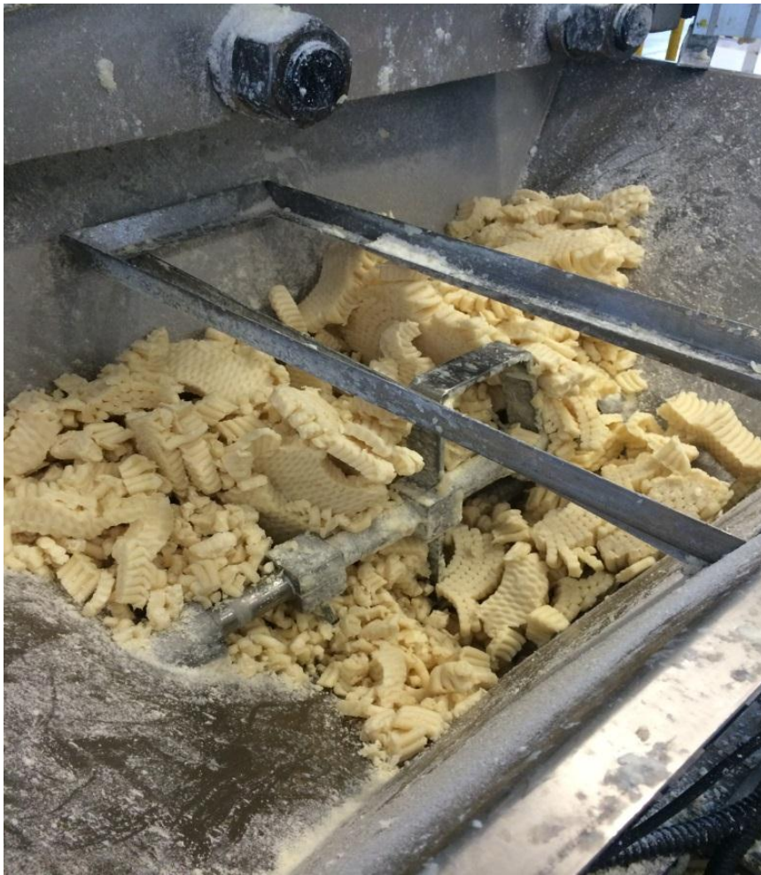
Figura 7 – Compactação de Massa na Válvula Rotativa
