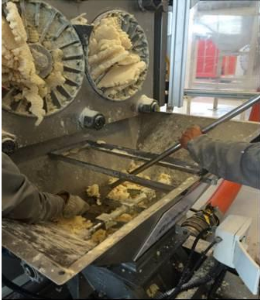
Figura 10 – Operadores realizando atividade de desobstrução do equipamento
