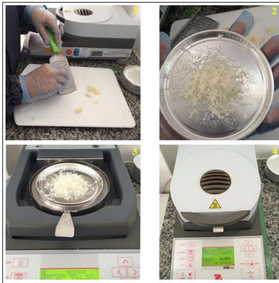
Figura 11 – Método de análise de umidade do noodle
