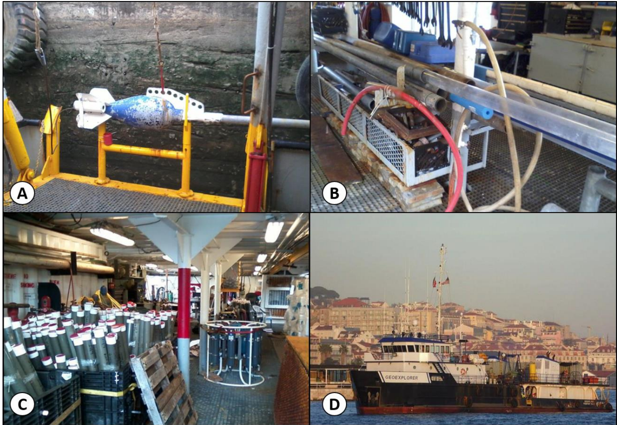
Figura 21 - Testemunho a pistão utilizado para a amostragem do estudo (A e B); Testemunhos recuperados (C); Navio Geoexplorer.
