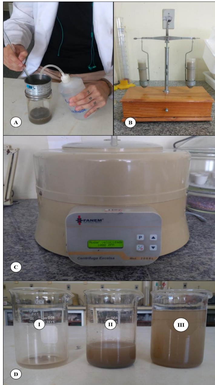
Figura 22 - Método de peneiramento a úmida para separação da fração areia das frações de silte e argila (A). Tubos de ensaio pesados a pares em balança de equilíbrio (B); Método de centrifugação a 1000 RPM para separação da fração silte e argila (C); Frações areia (I), silte (II) e argila (III) após o uso dos métodos descritos (D).
