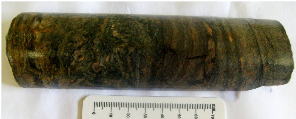
Figura 16- Foto de testemunho de furo de sondagem de muscovita quartzito (FMD-18/142) com foliação bem desenvolvida.
