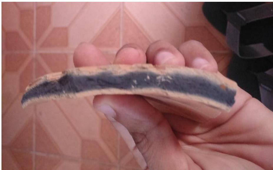
Figura 8 – material cerâmico com queima incompleta.
