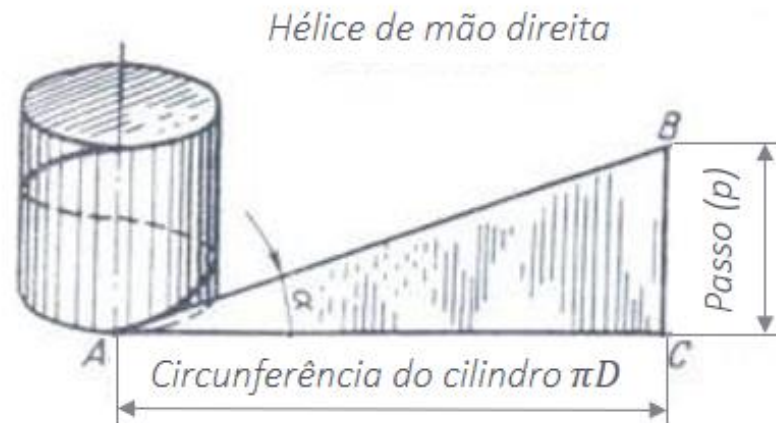
Figura 12. Perfil de rosca desenvolvido.
