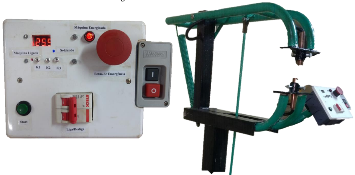
Figura 43. Sistema de controle.
