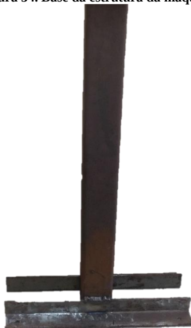
Figura 34. Base da estrutura da máquina
