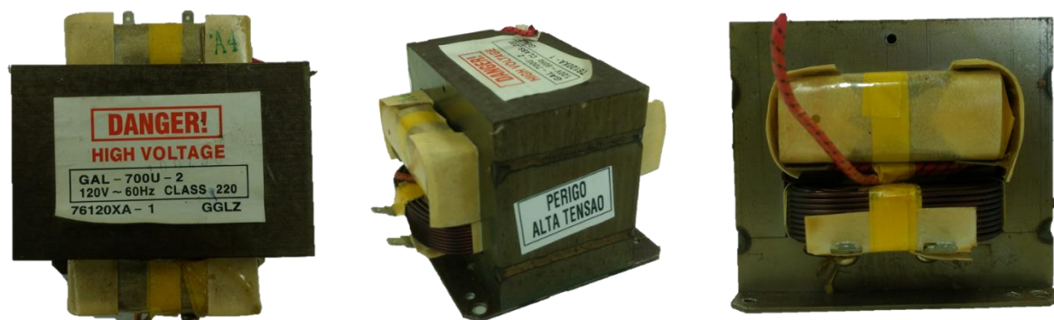
Figura 11. Transformador de micro-ondas.
