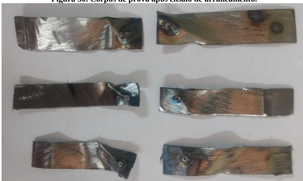
Figura 50. Corpos de prova após ensaio de arrancamento.
