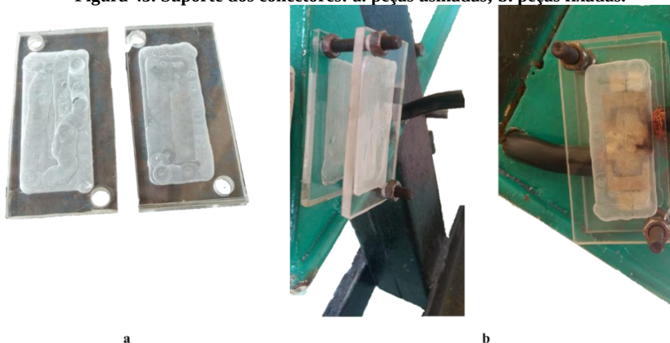
Figura 45. Suporte dos conectores: a. peças usinadas; b. peças fixadas.
