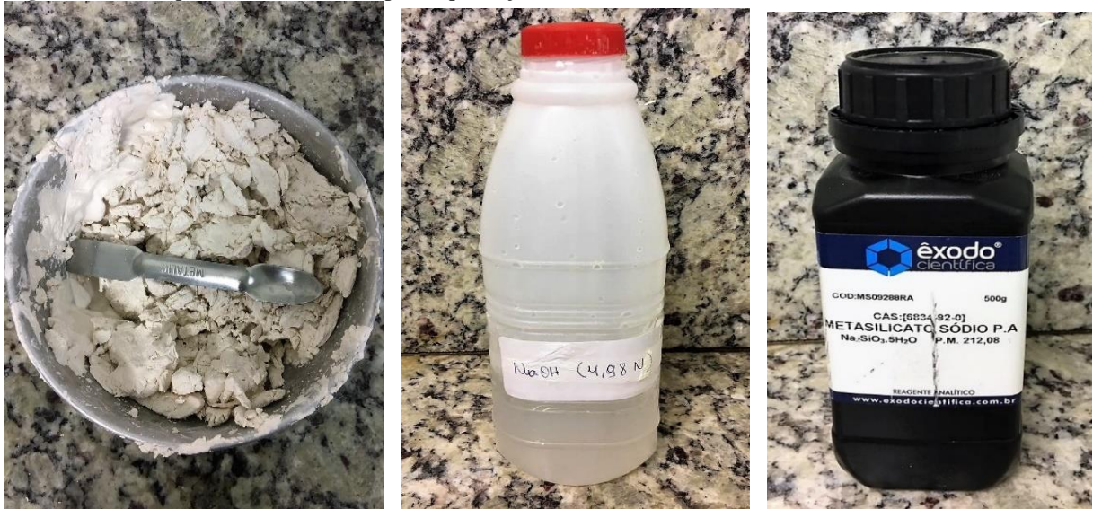
Figura 14- Principais materiais usados para a produção da zeólita Analcima
