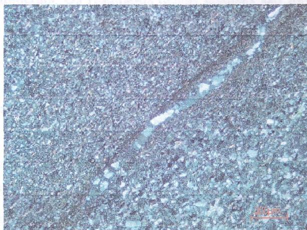
Figura 09: Fotomicrografia do subarcósio com nicóis cruzados, evidenciando a presença de veio de quartzo, objetiva de 5X/0,20 pol.(Amostra 07/TU-02)
