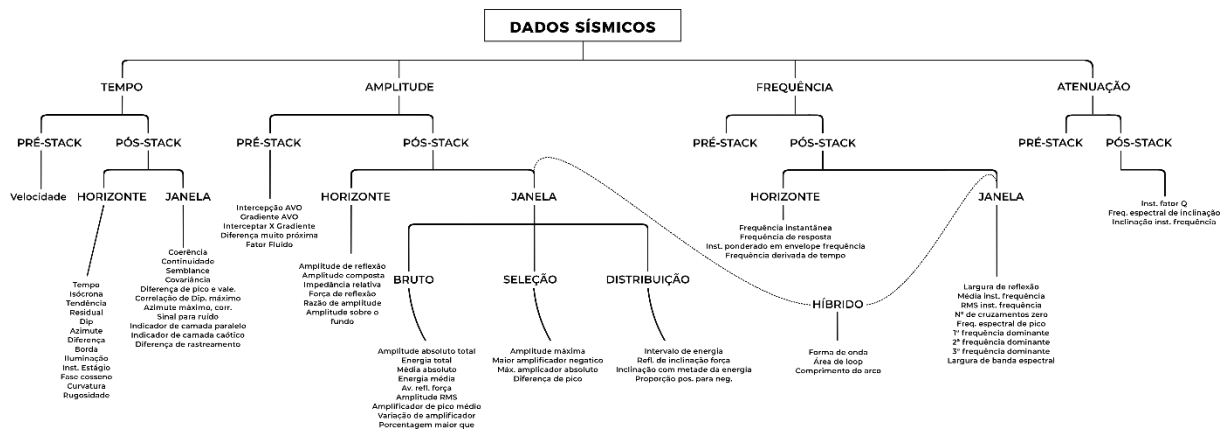
Figura 3.2: Atributos sísmicos derivados de informações sísmicas básicas, incluindo tempo, amplitude, frequência e atenuação. As janelas de análise podem ser definidas como um intervalo de tempo constante, um intervalo constante ancorado a um único horizonte, um intervalo entre dois horizontes. Adaptado de: Brown (2011).
