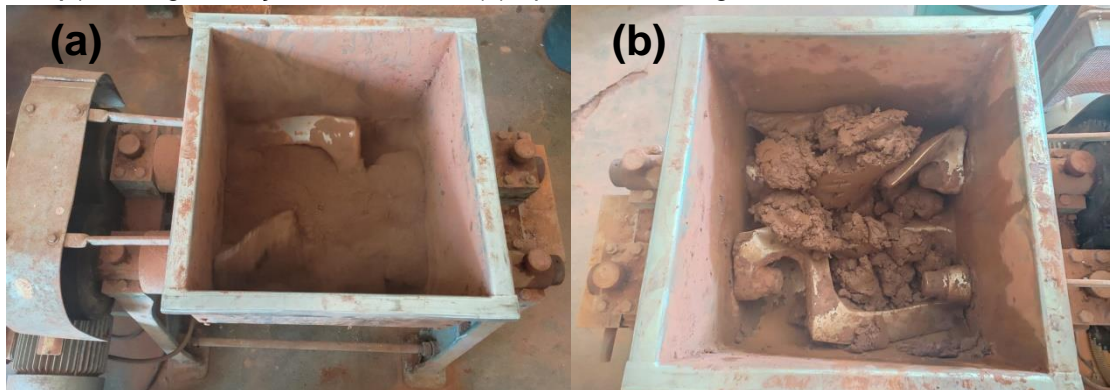
Figura 19 – (a) Homogeneização das misturas; (b) Após adicionar água
