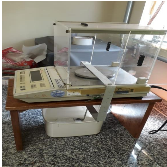
Figura 24 - Aparato utilizado para a medição das massas imersas
