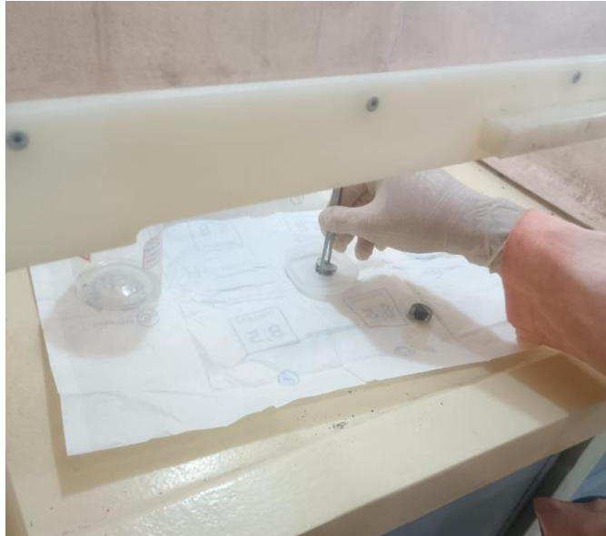
Figura 23 – Amostras com a superfície parcialmente submersa em HF
