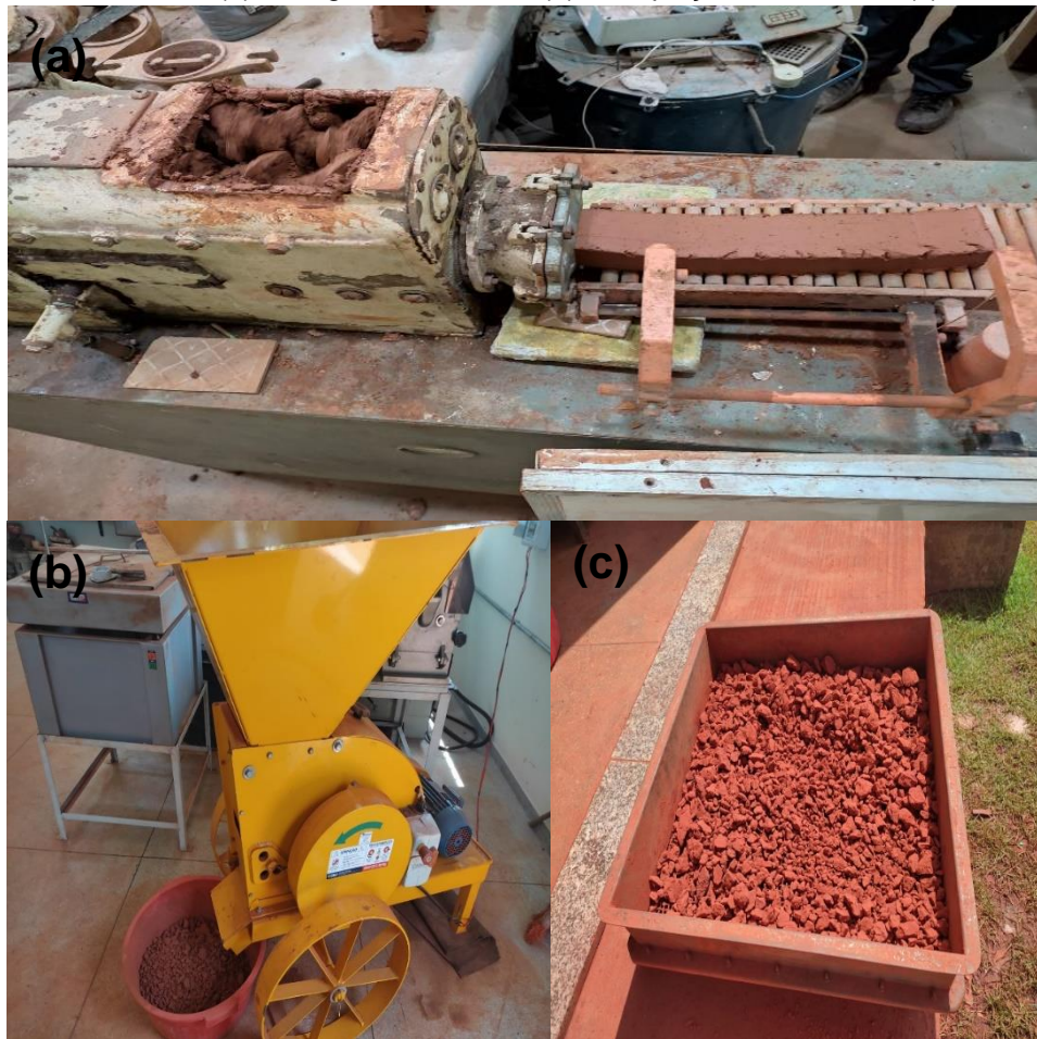
Figura 20 – Mistura extrudada (a); britagem do material (b); adequação dimensional (c)
