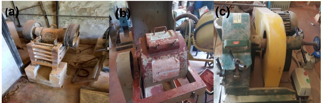
Figura 17 – (a) Britador; (b) Moinho de bolas; (c) Moinho de discos
