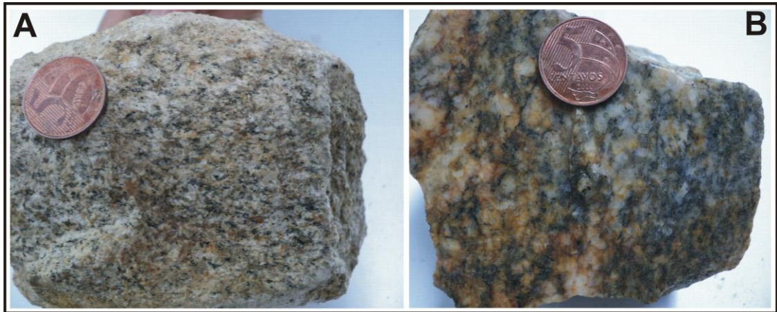
Figura 17 – (A) Foliação em monzogranitos de granulação média, destacada pela orientação preferencial das lamelas de biotita, ponto MC-169; (B) Monzogranito de granulação grossa, com orientação dos cristais de plagioclásio, ponto MC-180.
