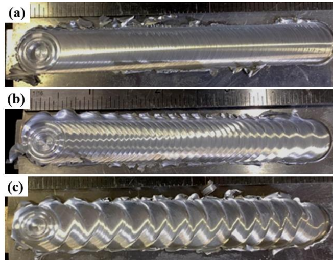
Figura 23: Identificação de rebarbas:
