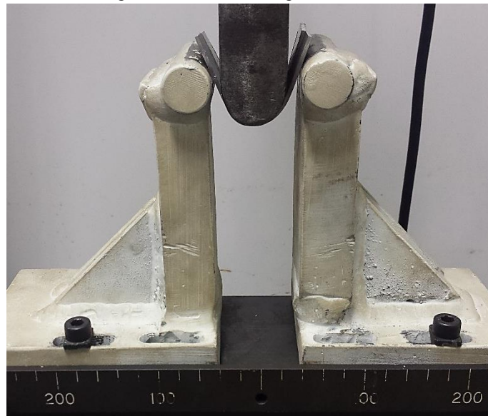
Figura 19: Dobramento guiado de face.
