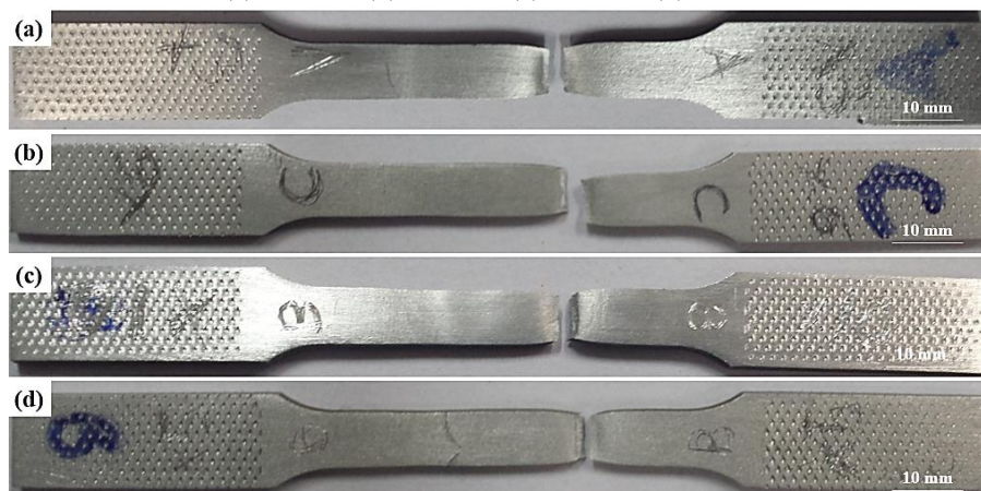
Figura 27: CPs pós ruptura: (a) 0,0 mm, (b) 0,5 mm, (c) 1,0 mm, (d) 2,0 mm
