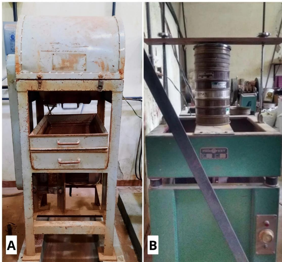
Figura 4 - Moinho de bolas (A) e peneirador automático com conjunto de peneiras (B).
