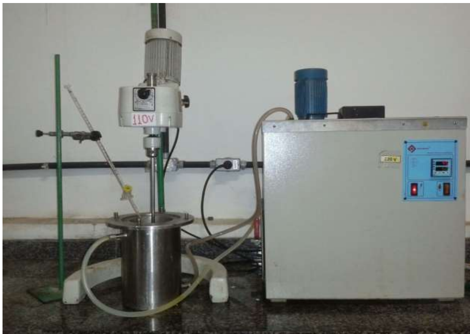
Figura 13 – Sistema utilizado para neutralização do óleo bruto
