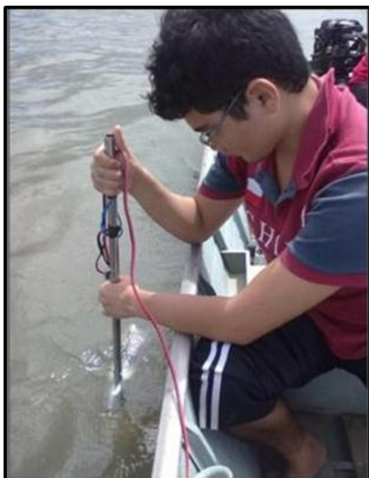
Figura 24 - Molinete Fluviométrico JCTM modelo MLN-7.
