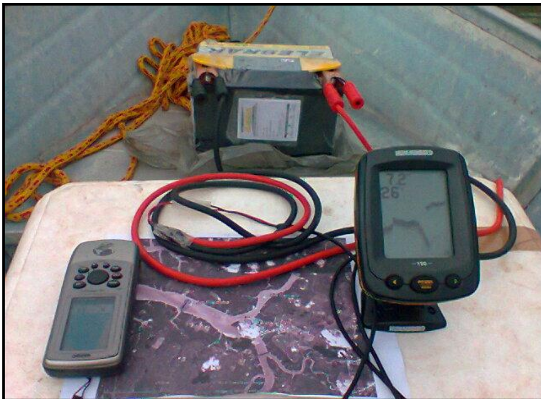
Figura 25 - Levantamento batimétrico com EcoSSondaHumminbird Piranha Max 180
