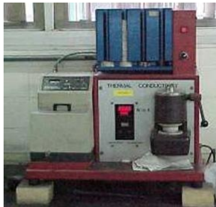
Figura 4. Equipamento para medição da condutividade térmica.
