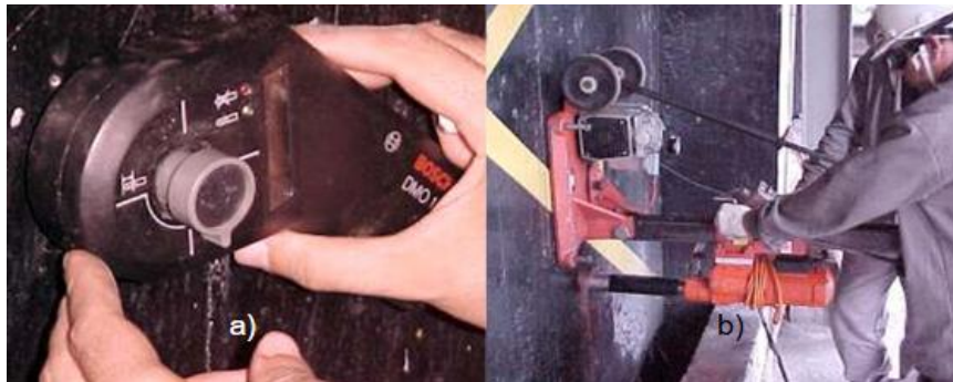
Figura 2. Equipamentos. (a) Pacômetro. (b) Máquina extratora.
