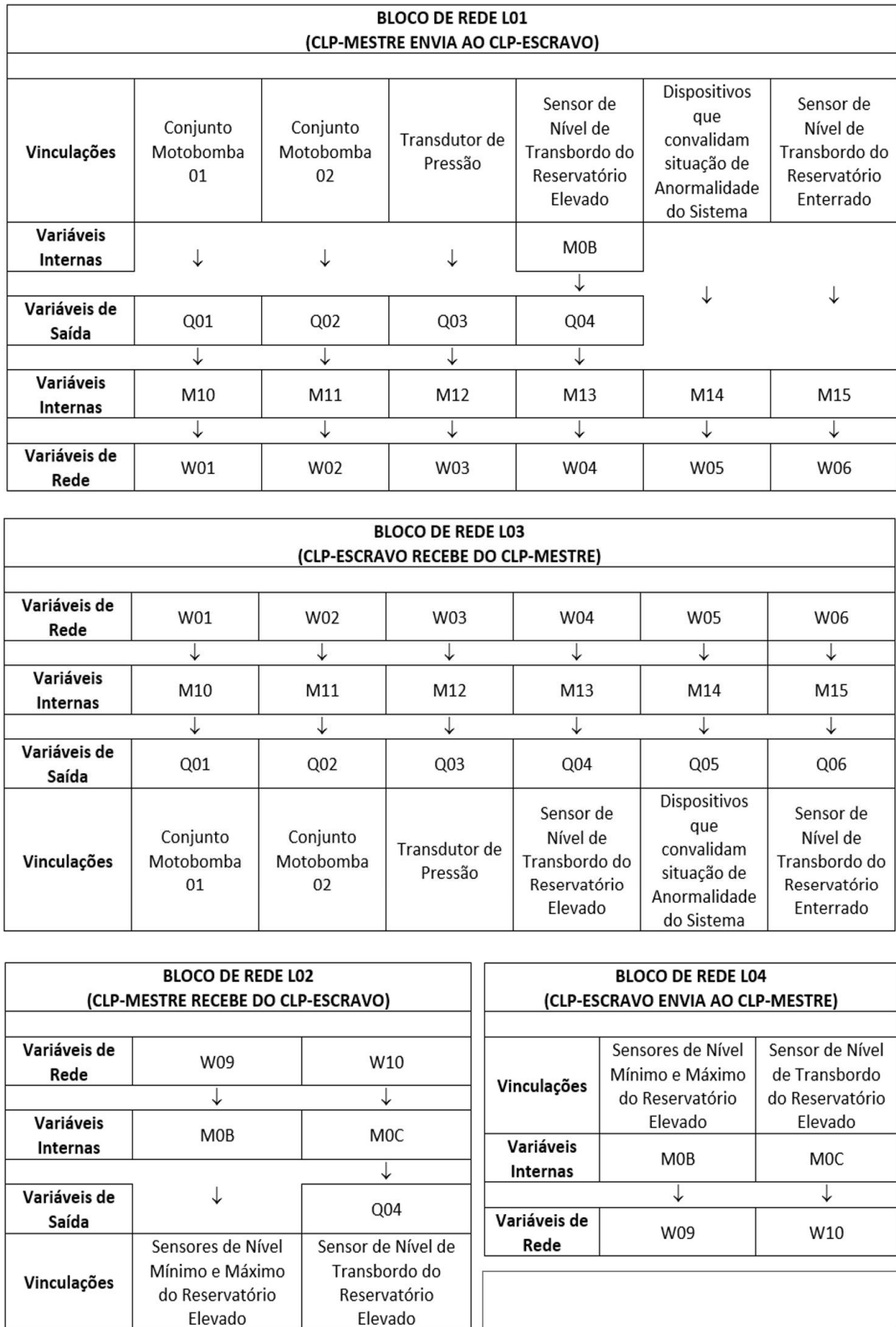
Figura 46 - Blocos de rede indicando o fluxo de informações.
