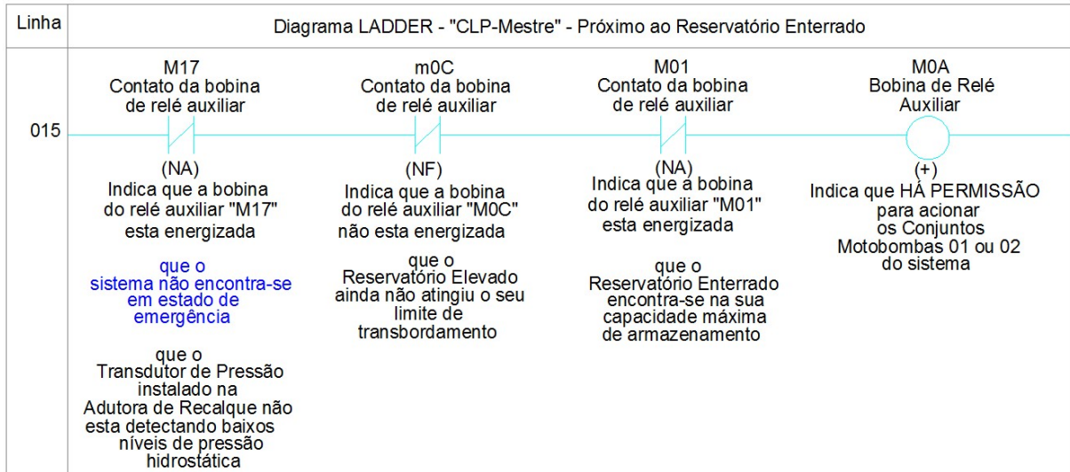
Figura 57 - Comportamento da linha de programação 015 do diagrama LADDER do CLP-Mestre quando houver permissão para o acionamento dos Conjuntos Motobomba 01 ou 02 (ênfase no Contato da Bobina de Relé Auxiliar "M17").
