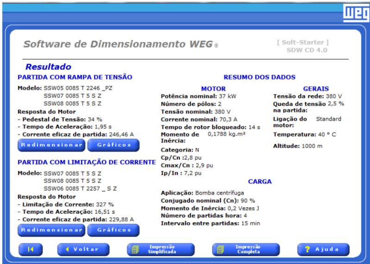
Figura 34 - Parametrização das Soft-Starters através do software SDW - Resultados.
