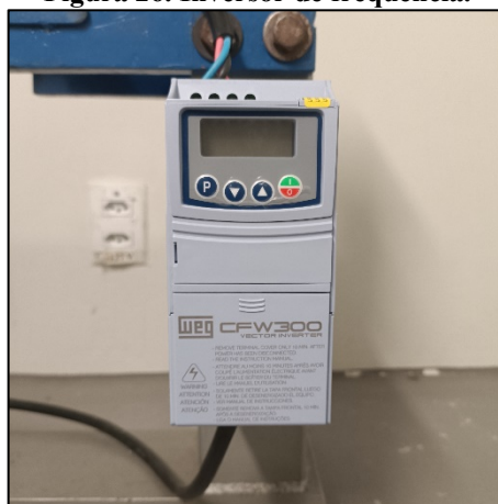
Figura 26. Inversor de frequência.
