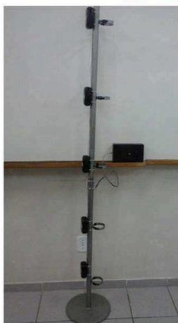
Figura 1.4: aparato que avalia o movimento da queda de um objeto.
